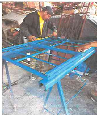
FOTO 3: INSTALACIÓN DE VENTANAS DE ALUMINIO MILL FINISH Y FABRICACIÓN DE VENTANAS DE METAL TIPO CORREDIZA.
